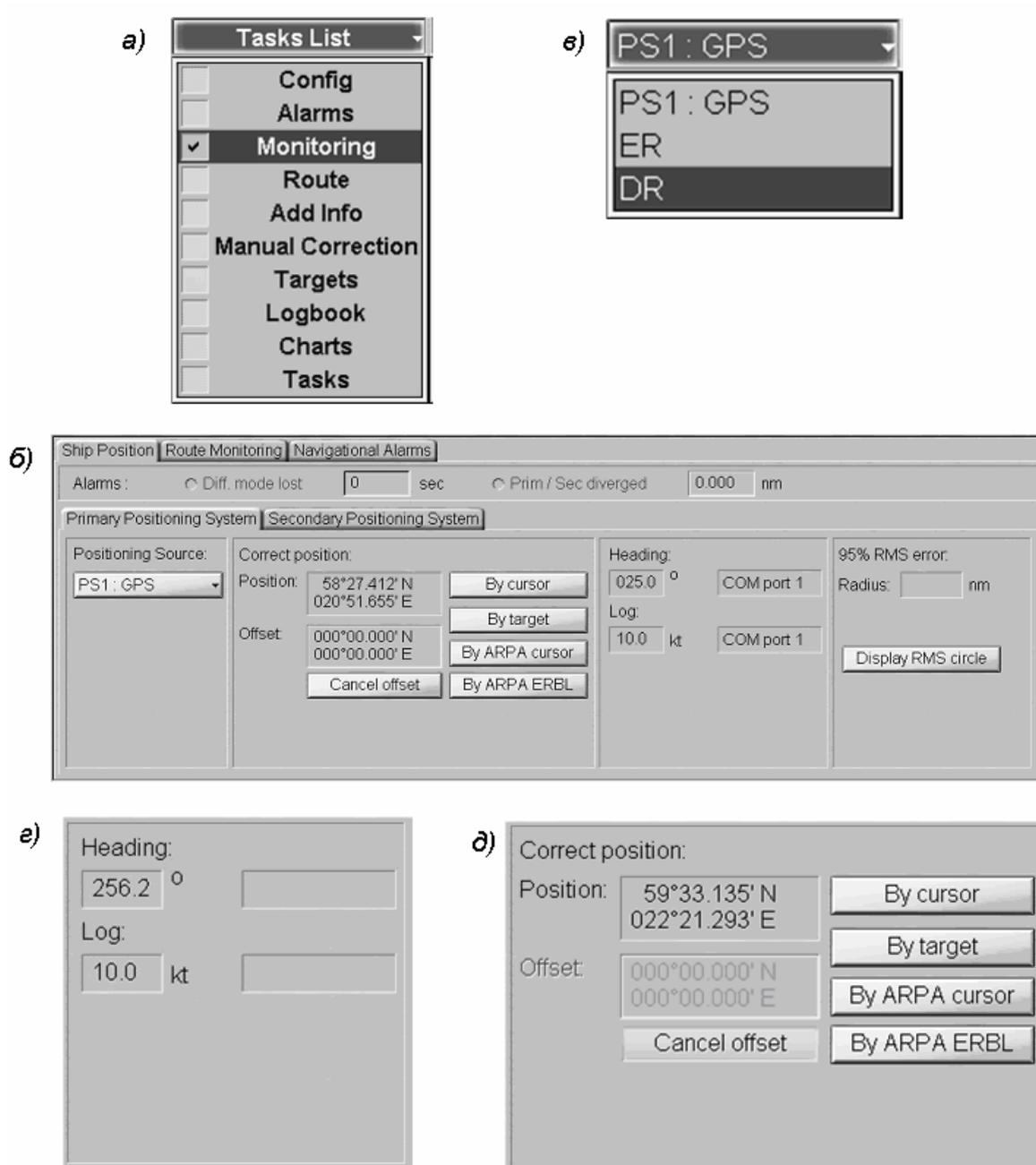
Рисунок 9.1 – Установка счисления как системы позиционирования в ЭКНИС
