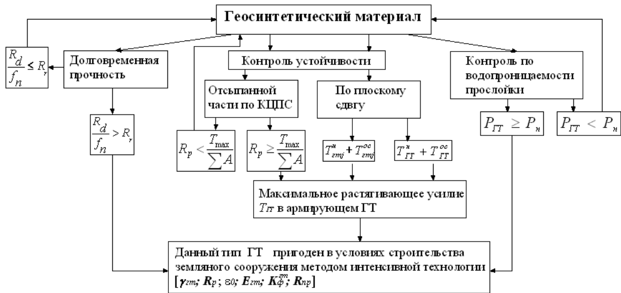
Рис. 1. Схема последовательности выбора и назначения геосинтетического материала при интенсивной технологии строительства земляного полотна
