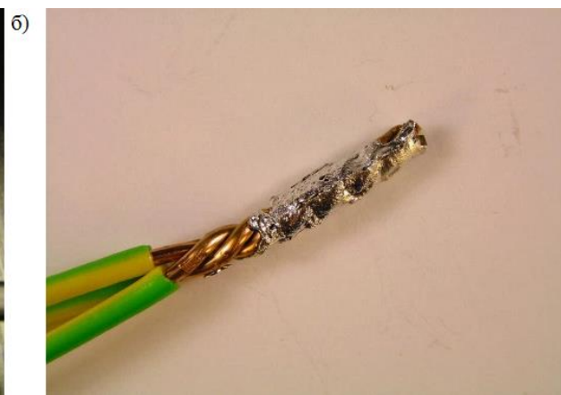
Результат лужения многожильного провода: а) отлично; б) удовлетворительно
